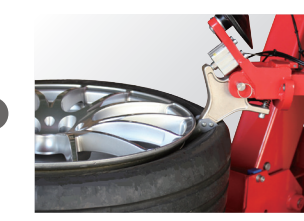
【自動】DTヘッドの挿入
