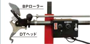
デュアルツールを反転することで、レバーレス操作を可能にするDTヘッド、タイヤ組込み時のBPローラーに切り替わります
